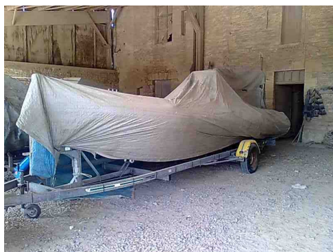
Bâché, frein de remorque non mis, roue jockey positionnée pour soulager les amortisseurs du Jumpy
