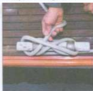
une demi-clé qui doit passer sous le dernier brin. Faites à
